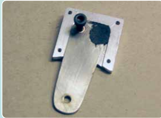
Så här ser det ut innan det skruvas/limmas ihop. Gummibiten gör att det fjädrar (lite).
