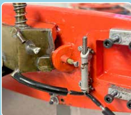
Utlösaren till avstängaren kommer från oket och har en skruv som gör att man lätt kan justera känsligheten.
