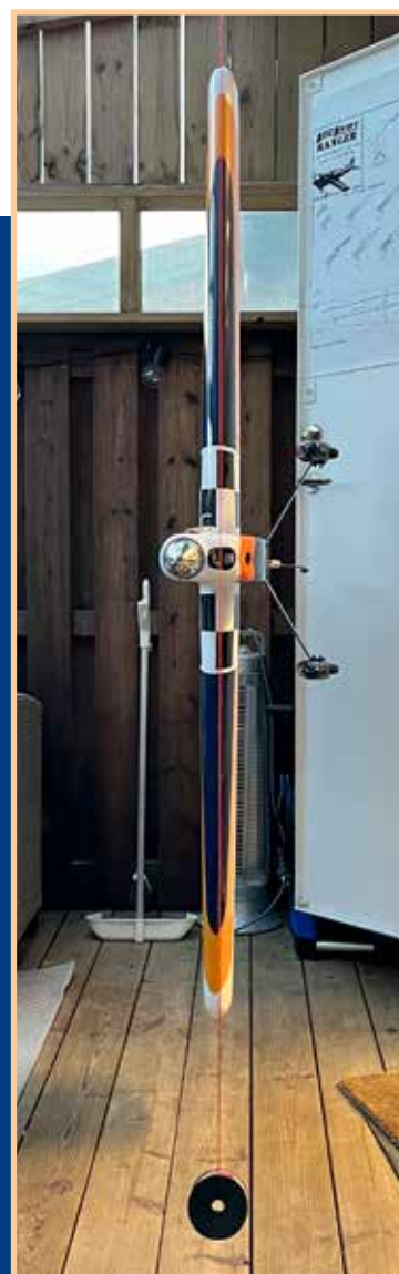
Den vertikala tyngdpunkten kontrollerades och visade att yttervingen ligger högt.
