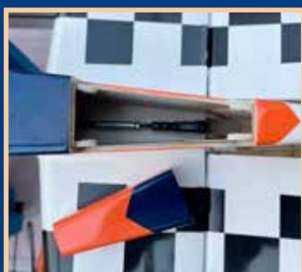
Längden på stötstängan kortades genom att skruva in linken ett varv vid höjdrodret.
