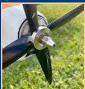
Modellen blev baktung och jag fick montera en tung bricka bakom propellermuttern.
