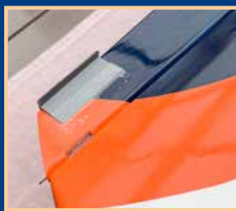
Vingen ligger nu rakt med hjälp av en trimtab på det yttre flapset.
