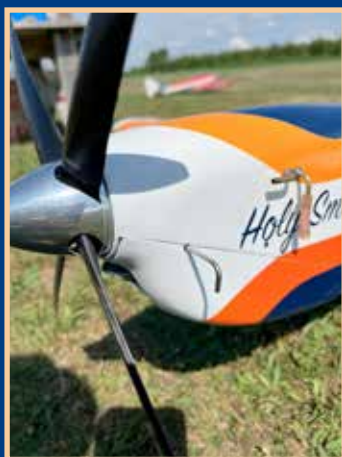
Hålet för nålen i kroppen fick filas upp. Nålen låg an mot kroppen och det påverkade motorgången.
