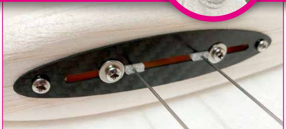
En av fördelarna med guiden är att den är löstagbar och t ex går att flytta till en ny modell.
